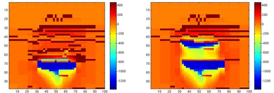
Sortie : cube 3D de propagation de la chambre de vapeur dans le réservoir
